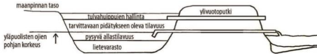
Kuvio 2. Leikkauskuva putkipadon rakenteesta (Heikkinen ym. 2012, 55.)
