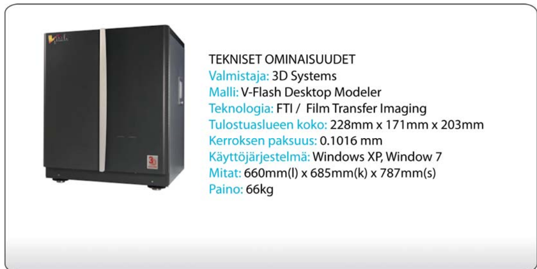
Kuva 16. V-Flash-tulostimen teknisiä tietoja. (Modelin3D.)
