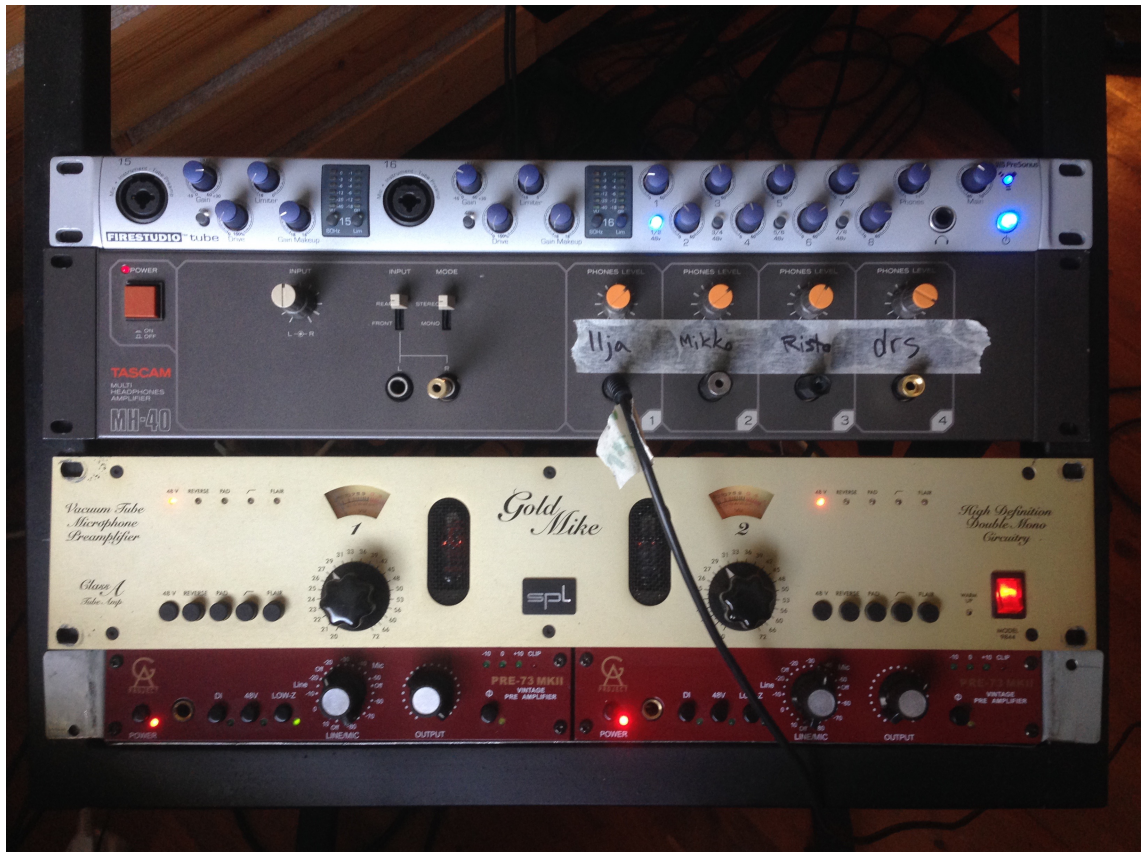
Kuva 11. Äänikortti, kuulokevahvistin ja erilaisia etuasteita, joilla projekti toteutettiin.
