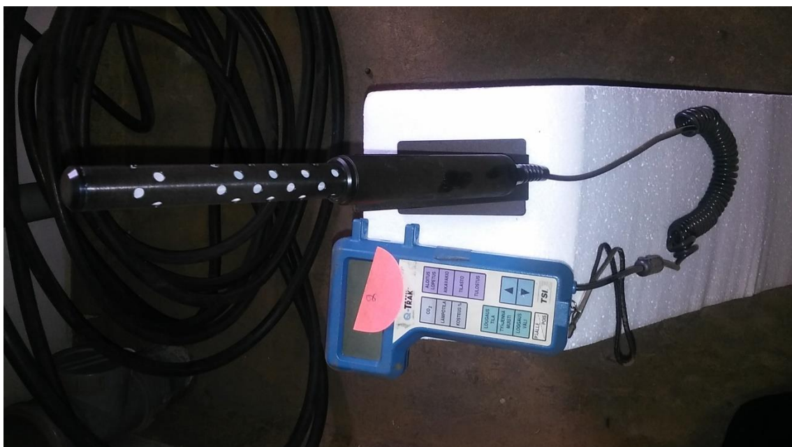
KUVA 13. Q-track sisäilman laadun mittari.
