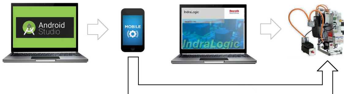
Kuva 9. Ohjelmoinnin topologia [3; 13]. Älylaitteelle ohjelmoidaan applikaatio Android Studiolla, PLC:hen ohjelmoidaan ohjelma IndraLogic-ohjelmointityökalulla. Tämän jälkeen servokäytön ja siihen sulautetun PLC:n ohjaamiseen tarvitaan ainoastaan kyseistä älylaitetta.
