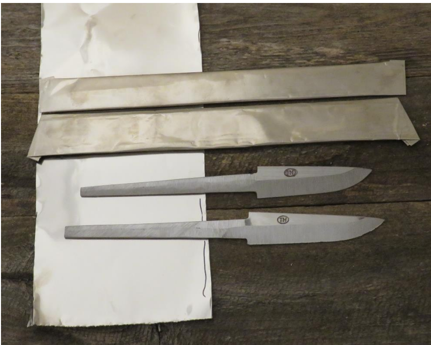
KUVA 11. Terät suojataan Ticonic-lämpökäsittelyfoliolla
