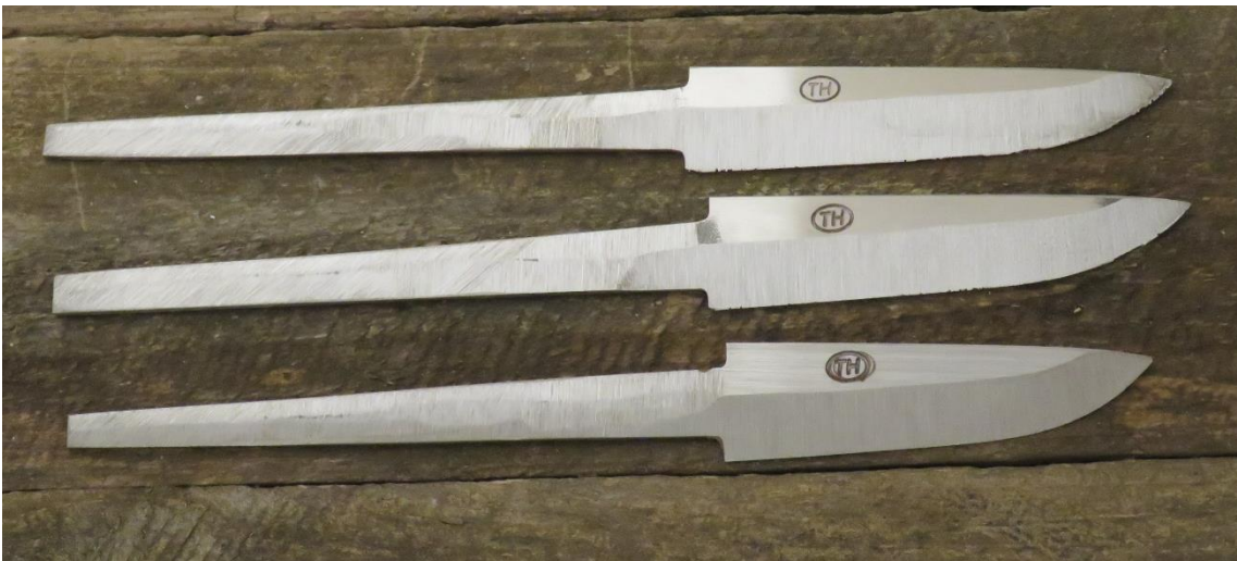
KUVA 10. Puukonterät hiottuina ja valmiina lämpökäsittelyyn
