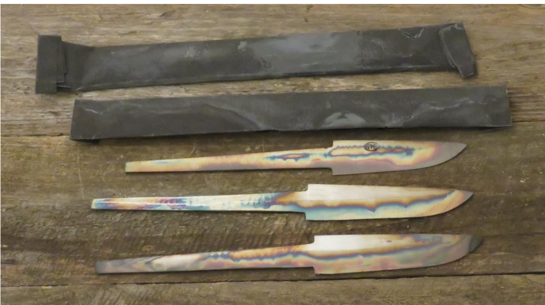
KUVA 14. Onnistuneesti karkaistut terät
