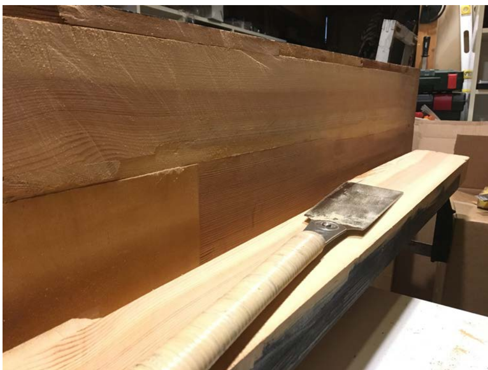
Kuva 25. Sahatun sivupaneelin siistimpi lopputulos
