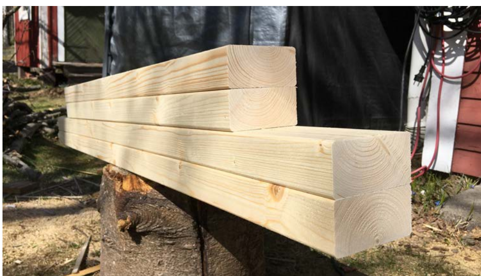
Kuva 28. Mittaan sahattua puutavaraa tukirakenteeseen
