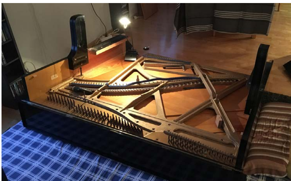
Kuva 15. Harpun poistaminen vaatii koko etupuolen purkamisen
