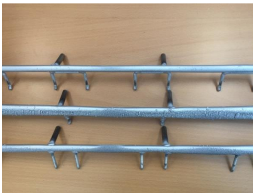
Kuva 3. Maalaamon nykyiset ripustinmallit.
