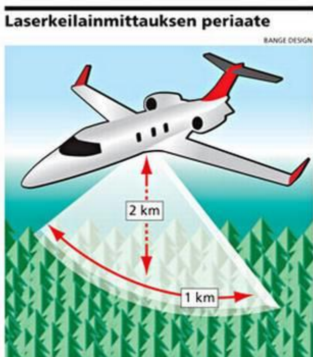
Kuva 2. Laserkeilainmittauksen periaate (Kuva: Tekniikka&Talous 2008).
