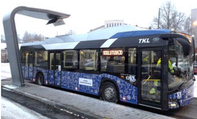
Kuva 4. Tampereen sähköbussi ja latausasema Pyynikintorin pääte pysäkillä (Tampere 2016).
