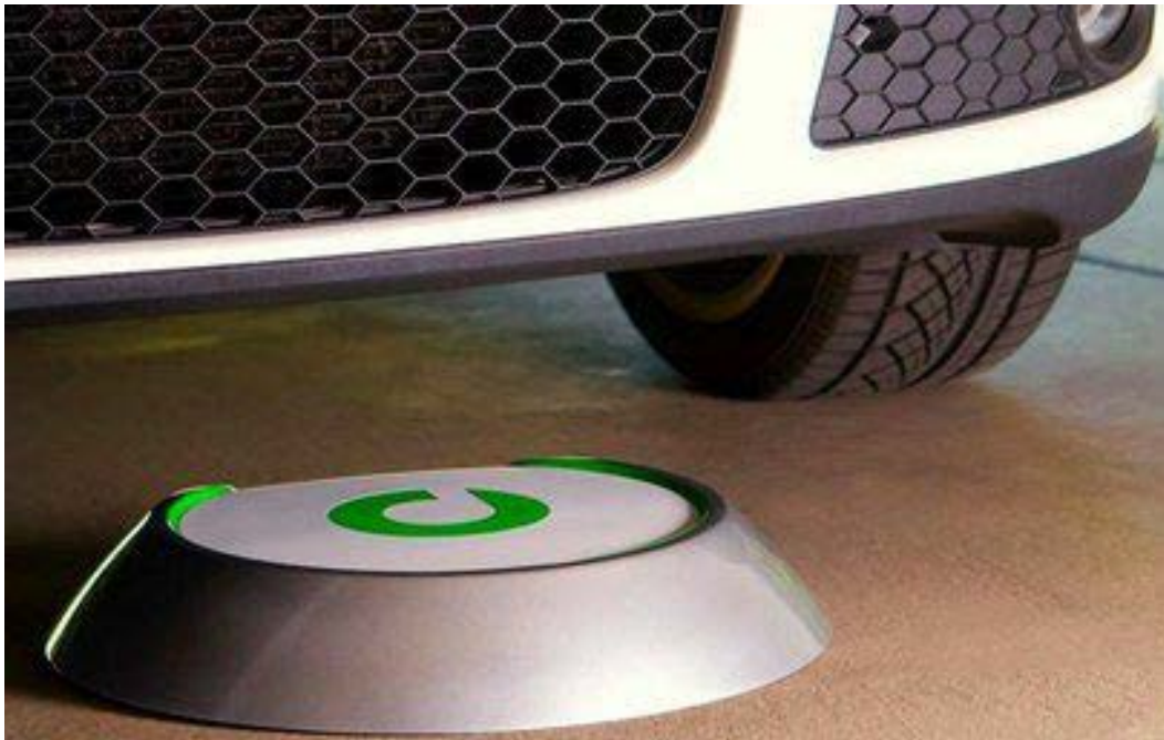
Kuva 5. Induktiivinen latausjärjestelmä Saksassa (TFOT 2017).
