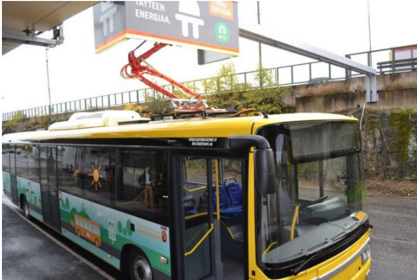
Kuva 1. Sähköbussi latautumassa Turun lentokentällä (Turkulainen 2016).
