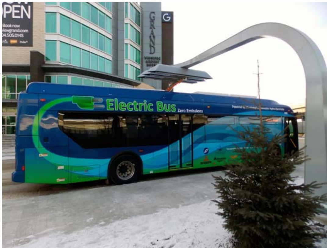
Kuva 7. Kanadan Winnipegin sähköbussi ja latausjärjestelmä (Winnipeg Transit 2017).
