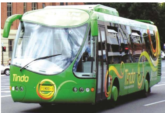
Kuva 8. Australian aurinkoenergialla ladattava sähköbussi (Denhere 2015).
