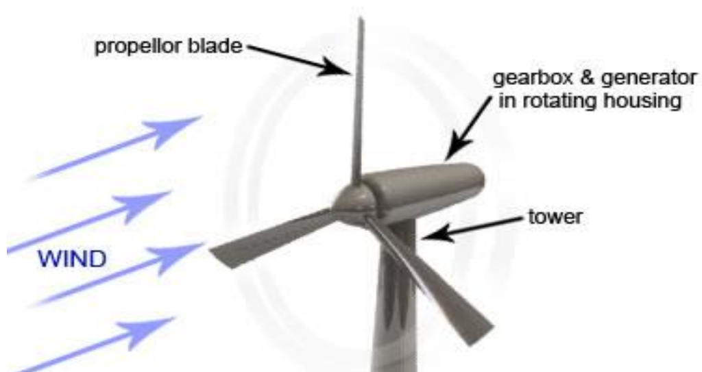
Kuva 9. Tuulivoimalan toimintaperiaate (Darvin.clara, 2016).
