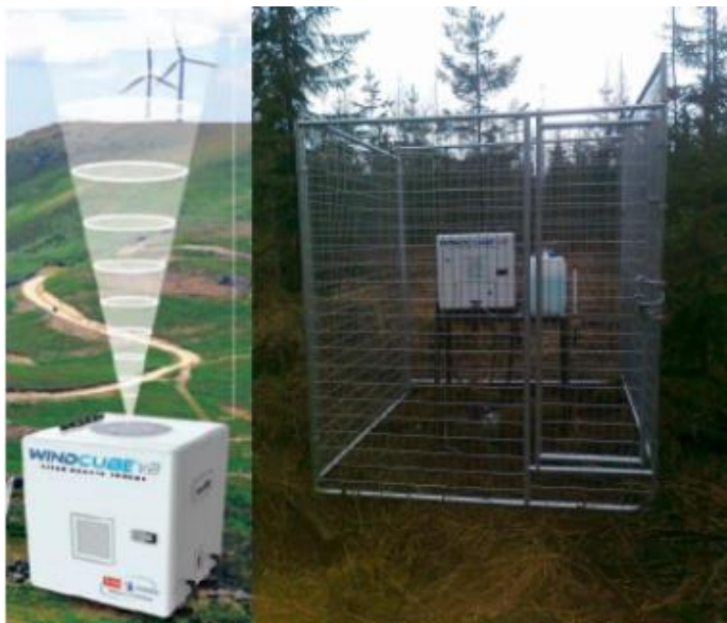
Kuva 22. LIDAR-mittaustapa vasemmalla, oikealla LIDAR oikea koko (Hynynen 2012).
