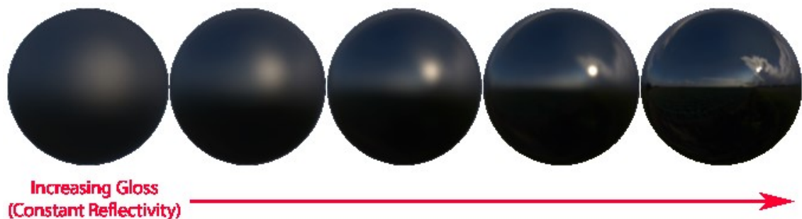
Kuva 8. 3d-mallin pinnan karheuteen vaikuttaa Roughness Mapilla.
