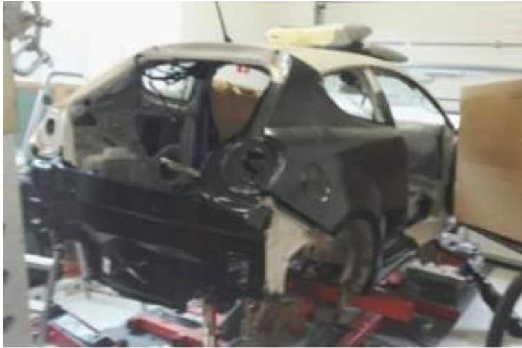
Kuva 12. Peltiosat kiinnitettyinä takaosaan.
