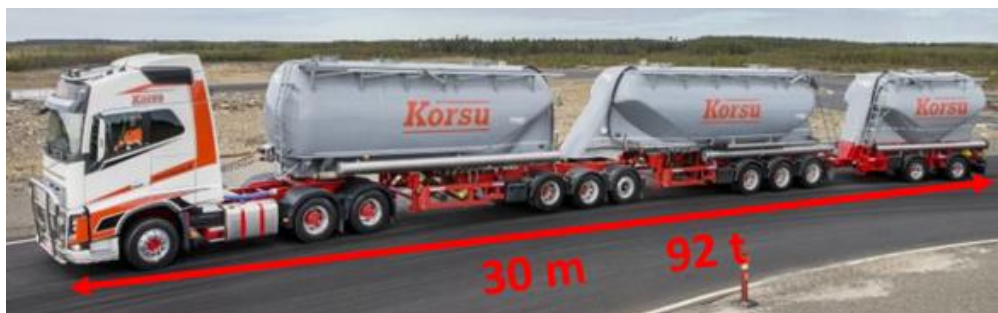
Kuva 18. Korsu Oy:n HCT-yhdistelmä. (Kaleva 2016, Kuvan mitta- ja massatiedon lisäys kirjoittajan).
