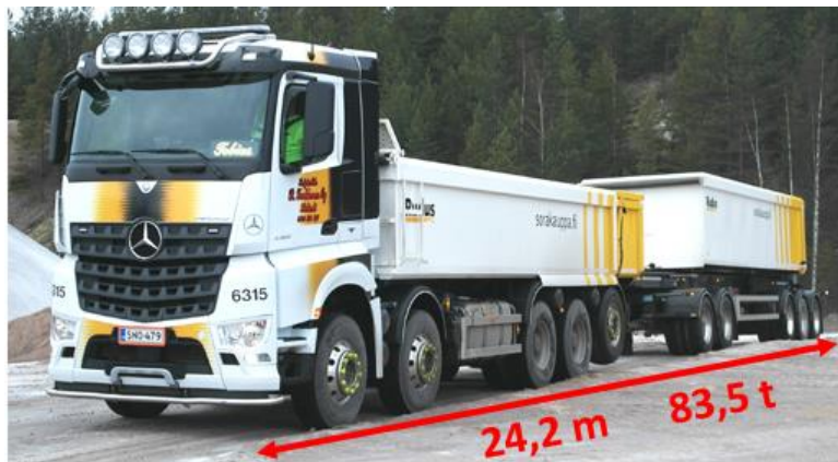
Kuva 20. Kuljetusliike R. Tarkkonen Oy:n HCT-yhdistelmä (Vehotrucks 2017, Kuvan mitta- ja massatiedon lisäys kirjoittajan).
