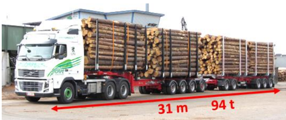
Kuva 11. Orpe Oy:n HCT-yhdistelmä (Orpe, Kuvan mita- ja massatiedon lisäys kirjoittajan).
