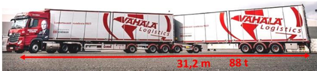
Kuva 16. Vähälä-yhtiöiden HCT, B-linkki (Raskaskalusto –lehti, Kuvan mitta- ja massa-tiedon lisäksi kirjoittajan)
