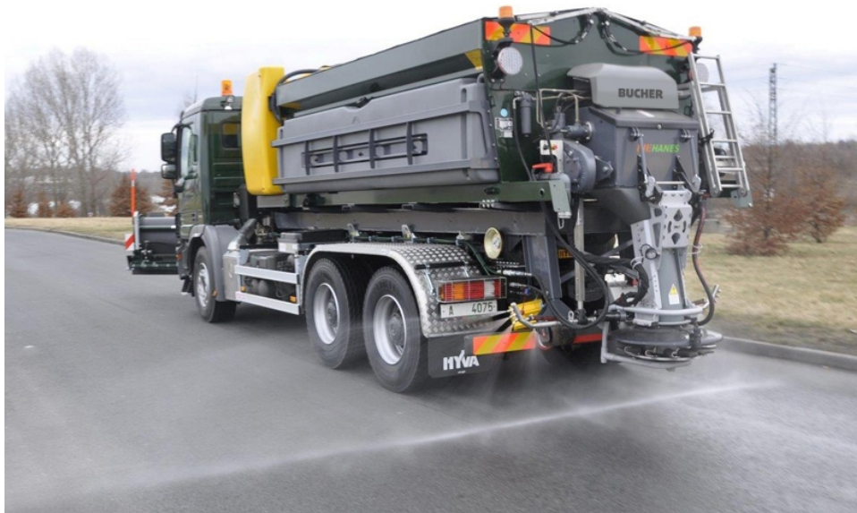
Kuva 7. Painesuuttimilla saadaan ruiskutustehoa liuksen levittämiseen (Bucher municipal 2016).
