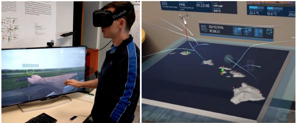
Kuva 13. Vasen: virtuaalisen tornin prototyyppi Oculus Rift -virtuaaliteollisuuslaseilla (Cordeil ym. 2016). Oikea: Microsoft HoloLens -älylasien kuvaa (HoloFlight 2016).
