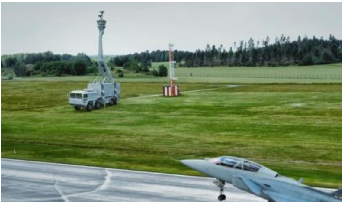
Kuva 18. Saabin siirrettävä kameramasto (Saab).
