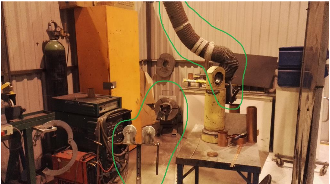
Kuva 7. Päätjuotospiste. Vihreällä on ympyröity juotosistukka ja kaasujen poistoputki. Kaikki muu kuvassa on tukiin valmistuksen kannalta tarpeetonta.
