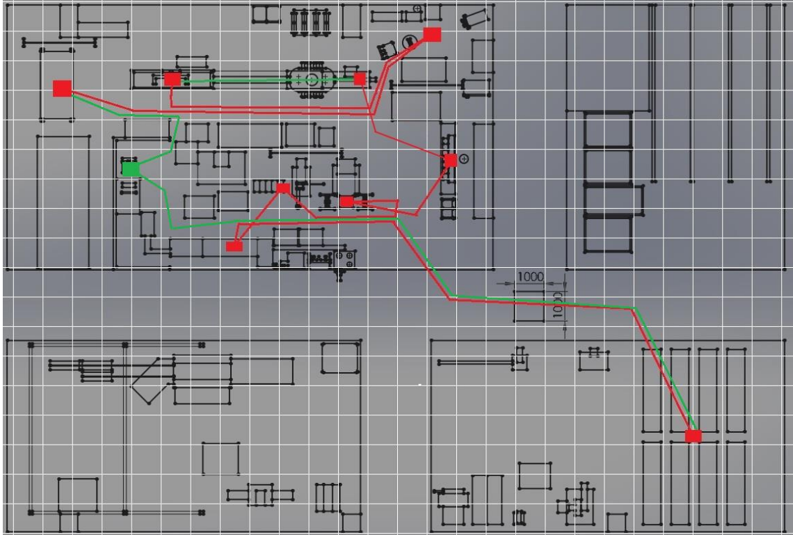
Kuva 20. Tukin liikkuma matka vanhalla layoutilla. Punaisella viivalla on merkitty työntekijän liikkuttava matka. Punaisilla neliöillä on merkitty eri työvaiheet. Vihreällä viivalla on merkitty tukin liike juotoskoneen läpi sekä työntekijän liike ilman tukkia. Liikerata on piirretty tukin keskipisteen kohdalta.
