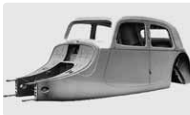
Traction Avant, Täyspeltinen monokokki
