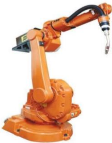
KUVA 40. Kaarihitsaus työkalu (Robotiikka 2016, 63)
