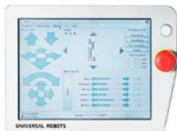
KUVA 42. Robotin käsiohjain (Robotiikka 2016, 49)
