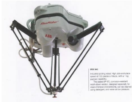
KUVA 29. Rinnakkaisrakenteinen robotti. (Robotiikka 2016, 16.)
