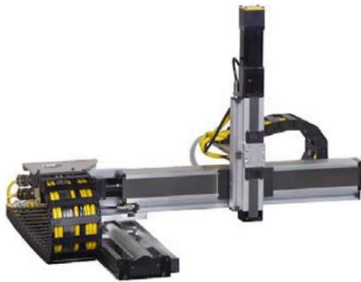
KUVA 24. Karteesinen robotti. (Robotiikka 2016, 12.)
