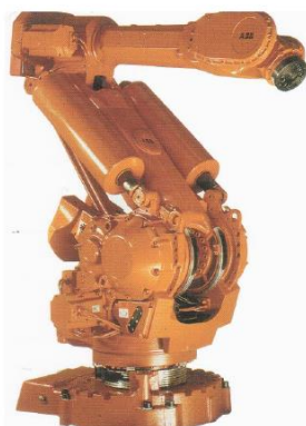
KUVA 28. Kiertyvänivelinen robotti. (Robotiikka 2016, 14.)
