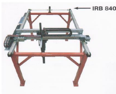
KUVA 23. Suorakulmainen robotit. (Robotiikka 2016, 12.)
