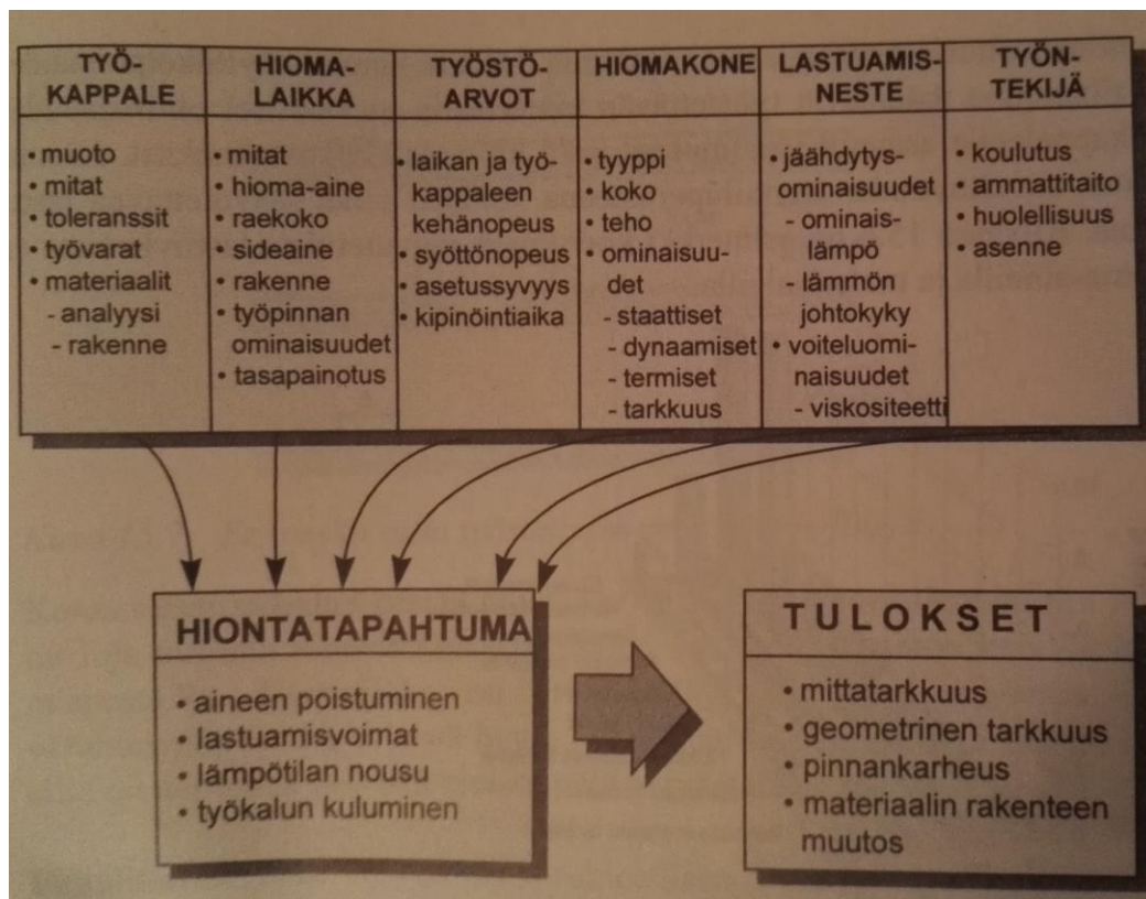
KUVA 15. Hiontatulokseen vaikuttavat tekijät (Aaltonen ym. 1997, 245.)
