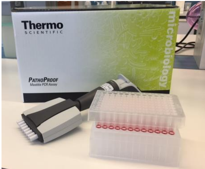
Kuva 2. L-kokoinen PathoProof DNA-eristyskitti, jolla voidaan eristää 384 näytettä. DNA kiinnitetään kuvassa näkyvään kolonnilevyyn, johon mahtuu kerrallaan 96 näytettä.
