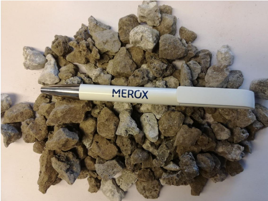
FIGURE 16. The LD slag 8–16 mm
