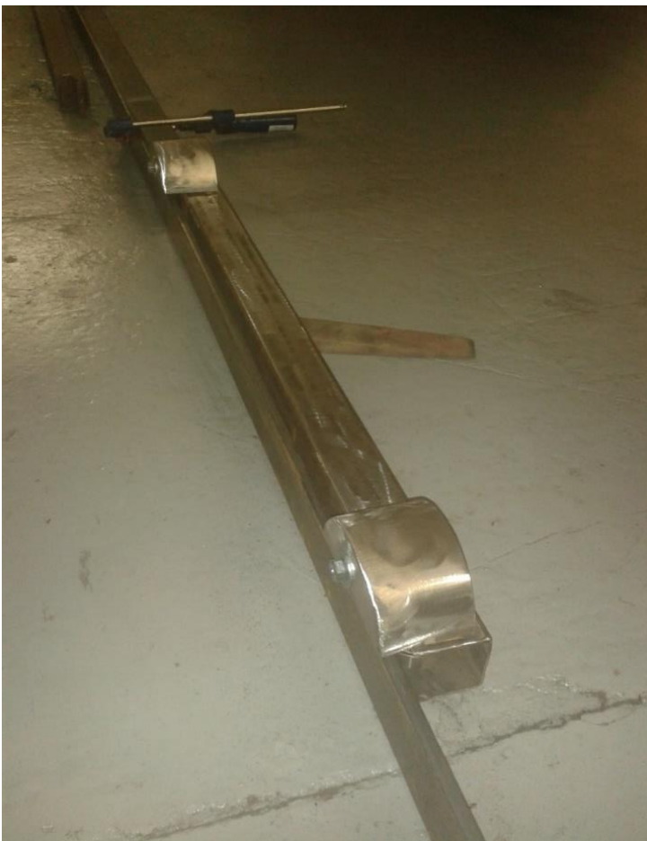
KUVA 6. Vannesahan kelkan rungon laakerointi.
