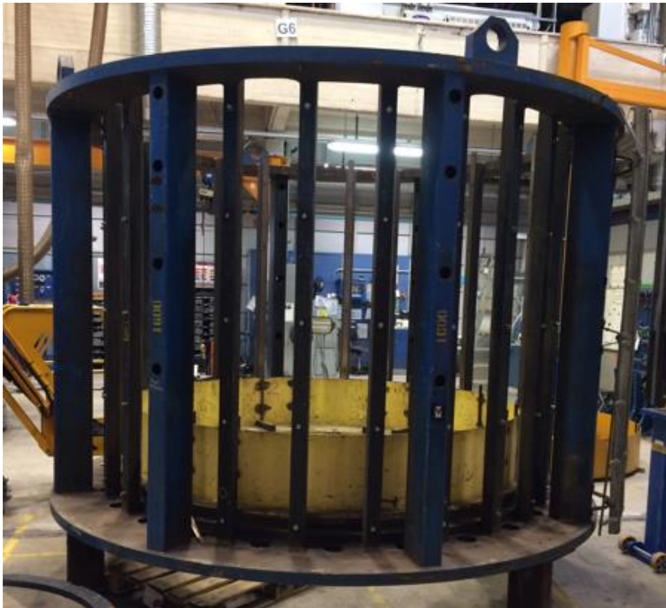
Kuva 13. Tietyin akselikorkeuden sähkökoneiden staattoripaketeille tarkoitettu ladontajigi.
