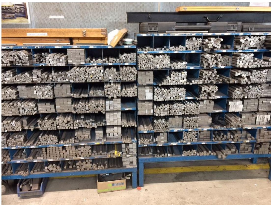
Kuva 18. Erikokoisia urapuikkoja vaaditaan suuret määrät urien leveyden vaihtelevuuden vuoksi.
