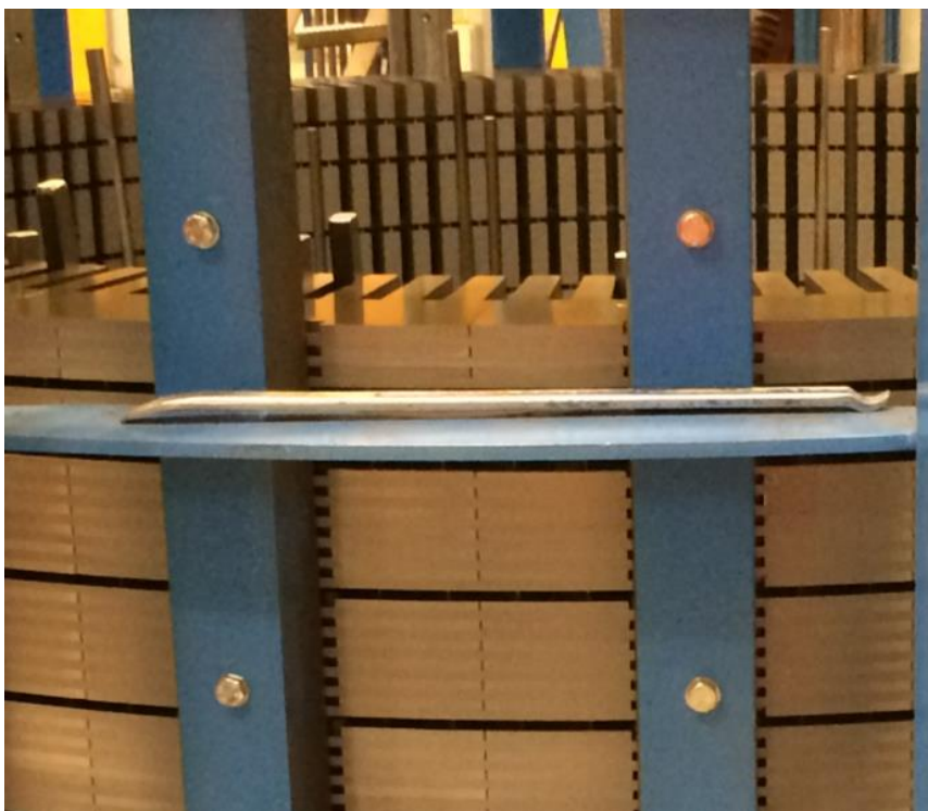
Kuva 19. Ladontajigin ohjauskiskojen kiristyspultit (P-ohjeisto 2017).
