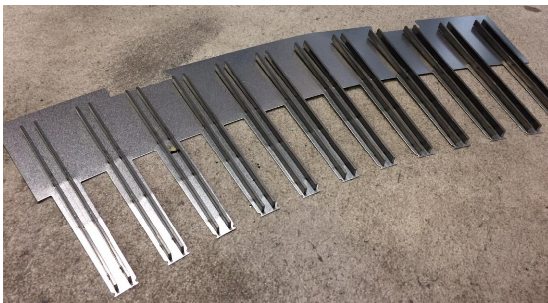
Kuva 15. Ilmasolalevy, jonka ilmasolatikut osoittavat ylöspäin.
