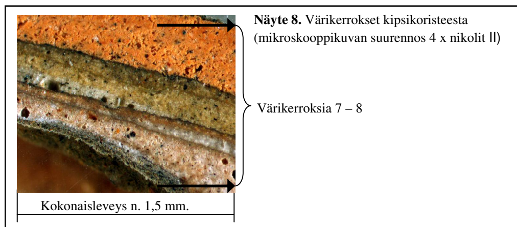
Kuva 53. Poikkileikkausnäytteestä voidaan usein laskea värikerrosten lukumäärä. (Lukkala 2009, 41.)
