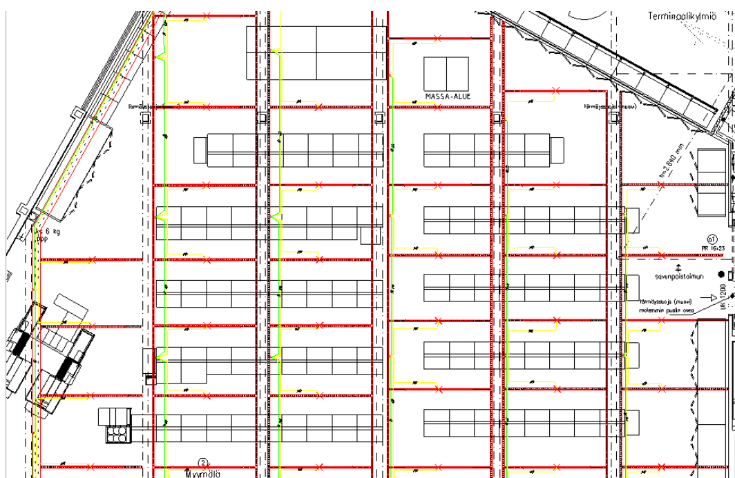
Kuva 23. Sijoitetut valaisimet, jakorasiat ja johdotukset.
