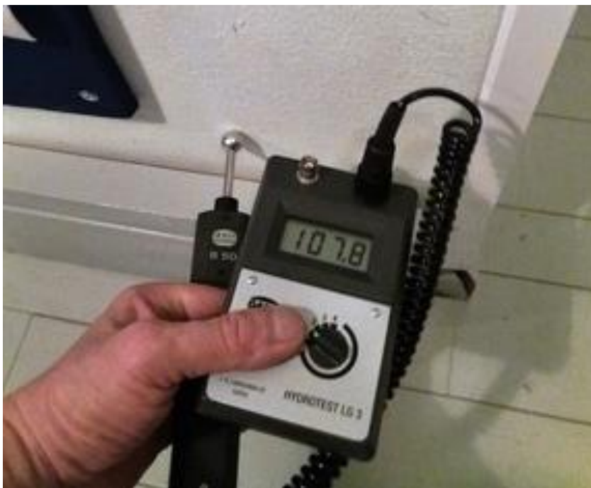
Kuva 11. Pintakosteuden mittaus. Suomenlinna C31. Kuvajaaja Pekka Vuorela. 2016.
