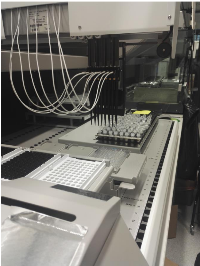
Kuva 3 Tecan Genesis RSP 150 –nesteenkäsittelyrobotti kahdeksan paikallisella LiHA-nesteannostelu varrella. Kuvasta voidaan nähdä stokkiliuosputket aseteltuna 96-paikkaiselle levylle ja läpinäkyvä 96-kuoppalevy, johon liuokset laimennetaan
