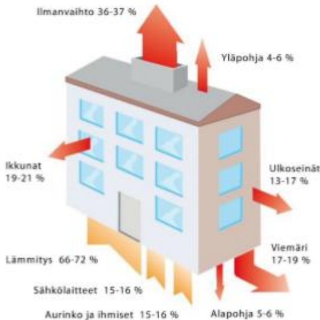
KUVA 5. Lämpöenergiatase 1960–1980-lukujen kerrostaloissa (4, s. 18)
