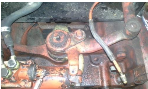
Kuva 45 Ohjaustehostin säätötanko irrotettuna
