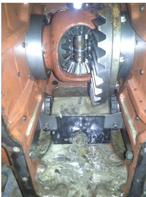
Kuva 37 Rikkoontunut taseuspyörästö sekä öljyn ja veden emulsiota
