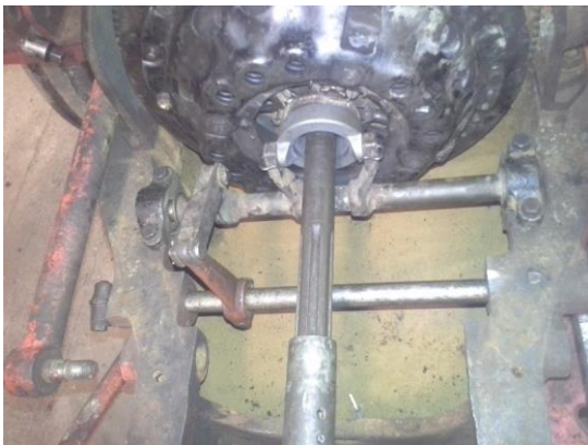
Kuva 30 Kytkin ja vivusto koottuna
