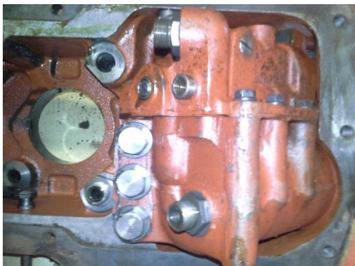
Kuva 43 Nostosylinteri hydrauliiikkaputket purettuna
