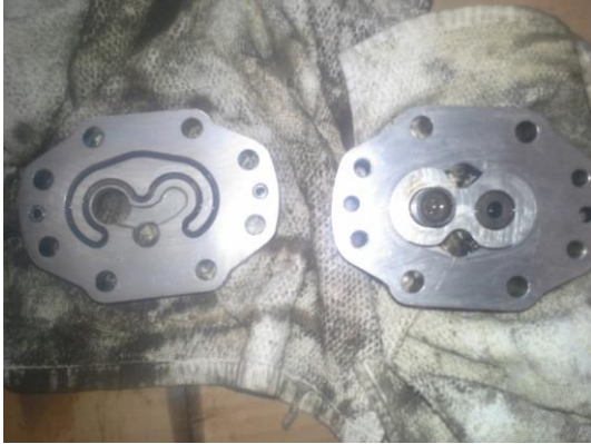
Kuva 44 Avattu hydraulikkapumpun pesä
