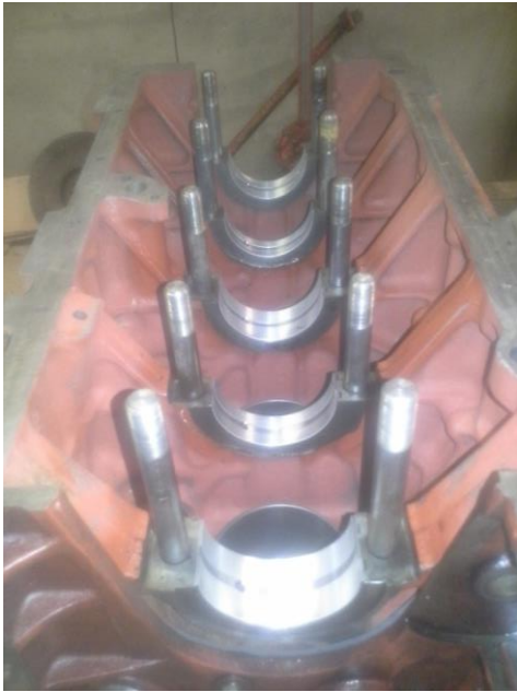
Kuva 19 Uudet runkolaakeriliuskat asennettuna
