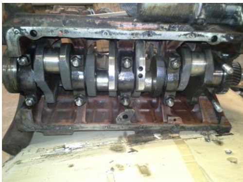
Kuva 17 Kampiakseli kiinni ennen irrotusta
