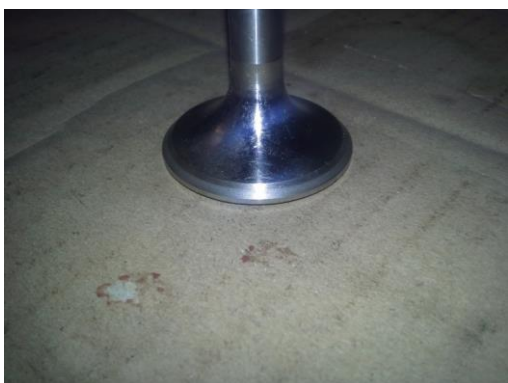
Kuva 23 Venttiilin istukkapinta hiottuna
