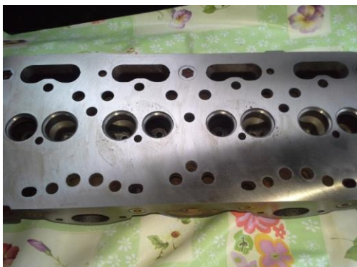
Kuva 22 Sylinterikansi tasohionnan jälkeen
