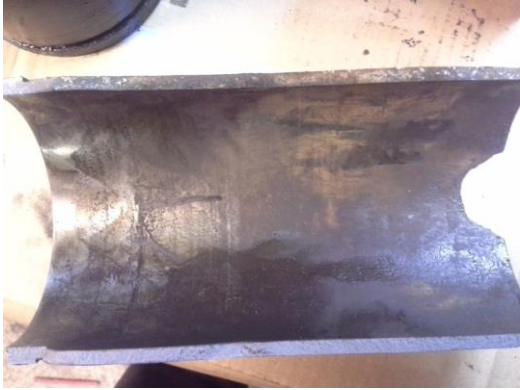
Kuva 14 Halkaistu sylinteriputki ja kaksi erilaista murtopintaa
