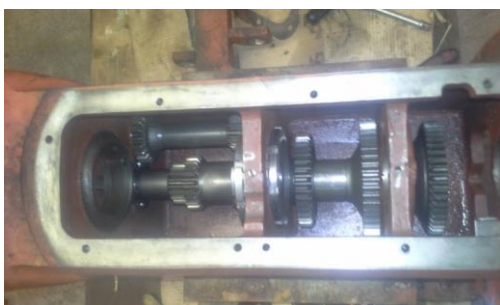
Kuva 41 Vaihteisto puhdistettuna ja ala-akseli koottuna
