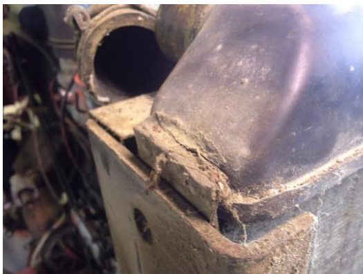
Kuva 4 Revennyt jäähdyttimen kehys
