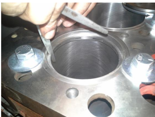
Kuva 18 Männänrenkaan päiden välysmittaus ja uudet sylinteriputket asennettuna
