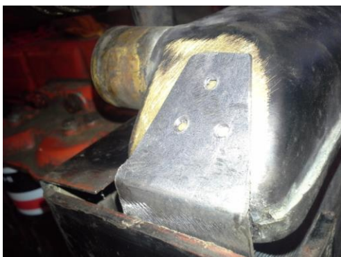
Kuva 32 Jäähdyttimen kehyksen korjauspala
