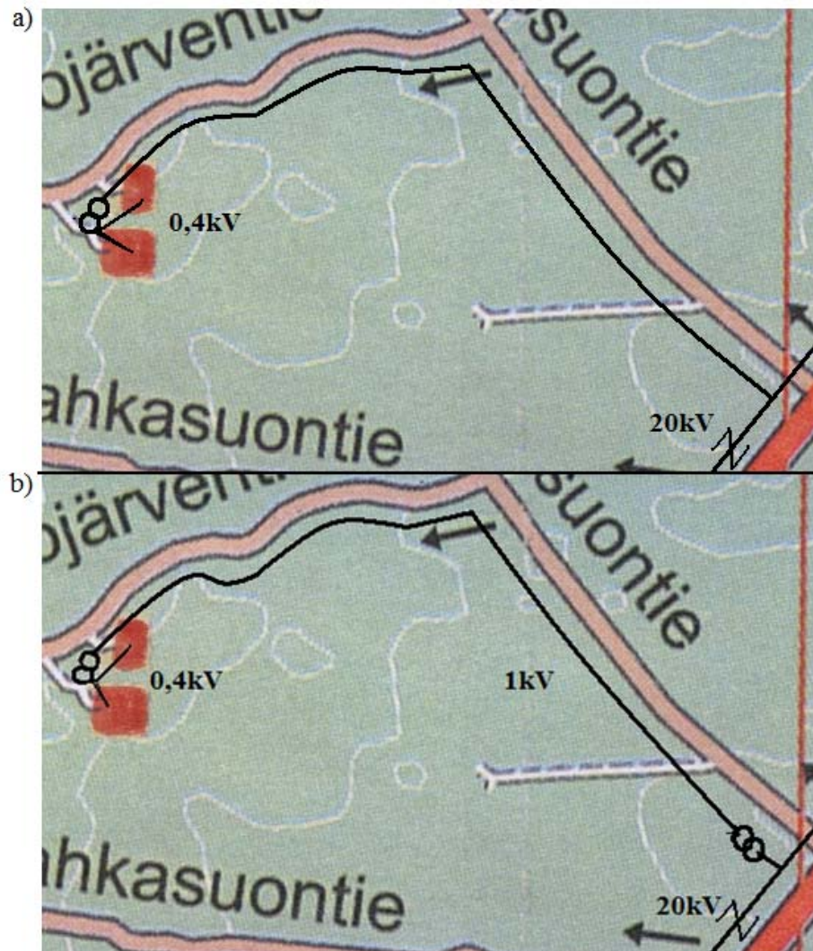
Kuvio 2. Kesämökkien syöttö a) perinteisellä ja b) kolmijänniteportaisella
