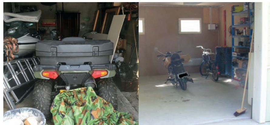
Autotalli, jossa on liikaa palokuormaa
