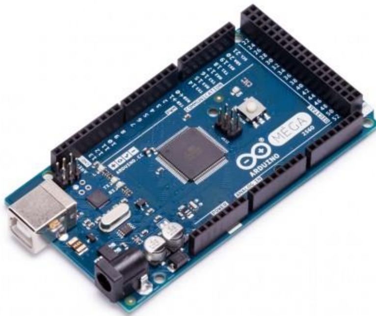
KUVA 18. Arduino Mega 2560 kehitysalusta (47)
