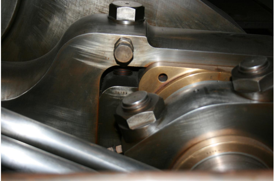
KUVA 13. Kampaikselin laakerin säätömekanismi. (Kuva: Roope Viita 2017)
