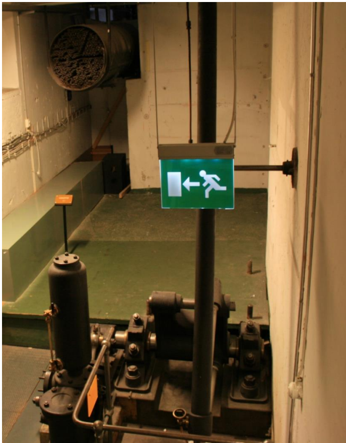
KUVA 6. Pumppu ja katkaistu putkilauhdutin. Pumppu pumppasi lauhduttimelta vettä ja ilmaa. Lauhdutin kuvassa vasemmalla ylhäällä. (Kuva: Roope Viita 2017)
