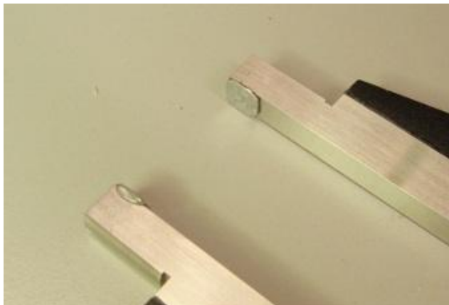
Kuva 24. Työntömitan leukoihin liitetyt lisäpalat (1 mm)
