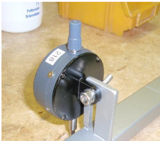
Kuva 22. Mitutoyo mittakellon takakansi silmukalla
