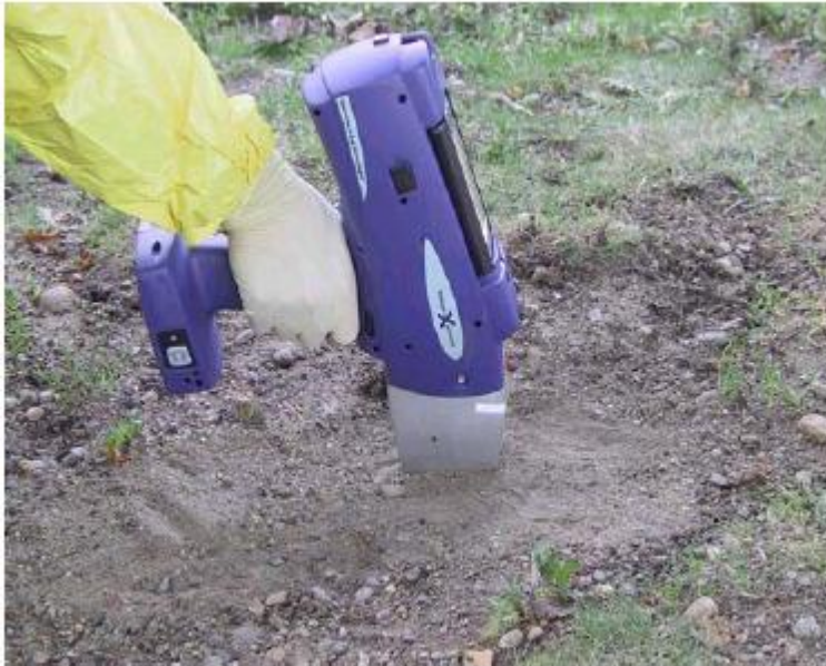
KUVIO 19. Näytteen analysointi in-situ (Innov-X Systems 2003.)
