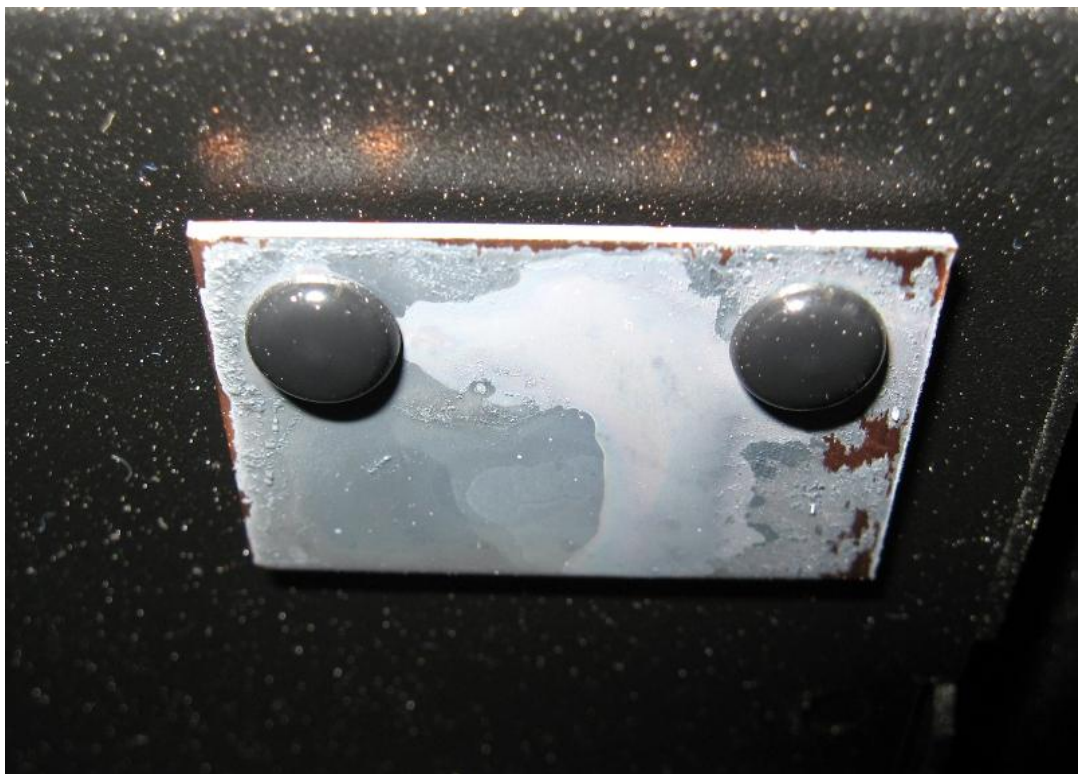
Kuva 2. Prosessiaseman korroosioindikaattori eli kuparilevy, joka on ollut korroosion vaikutuksen alaisena ja tummunut.
