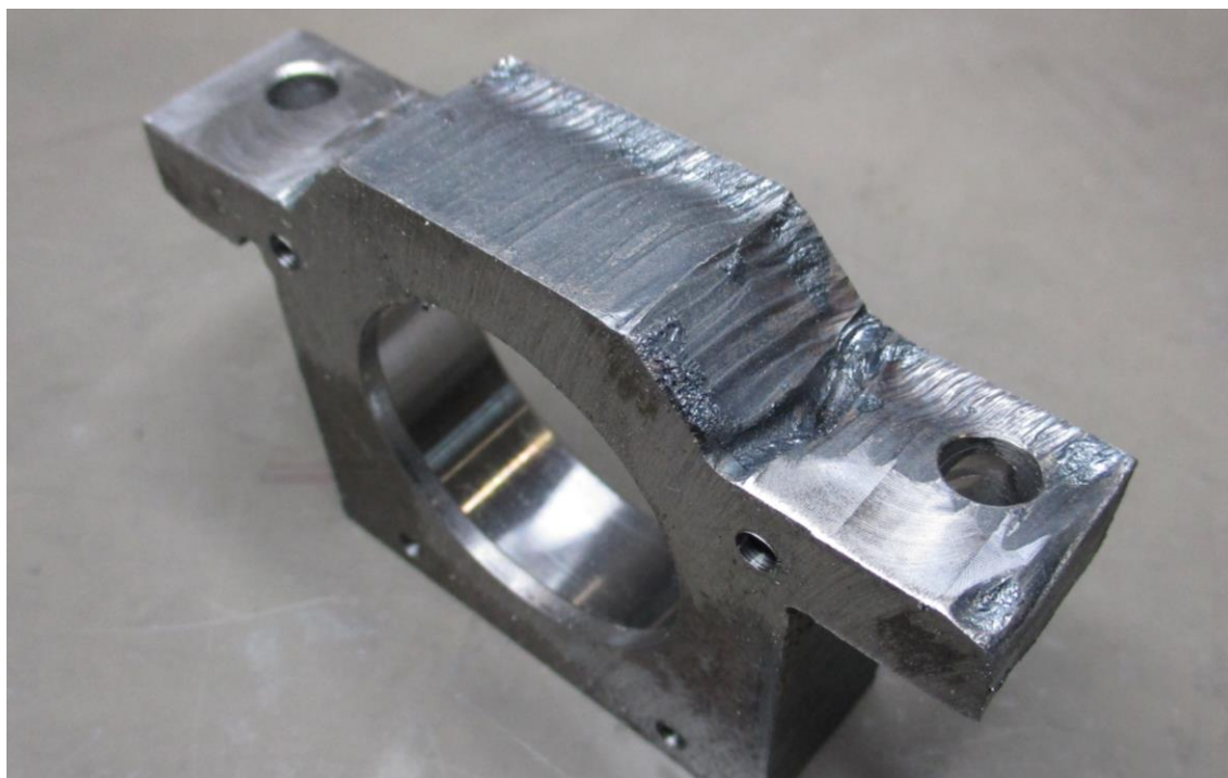
Kuva 34. Polttoleikattu aihio, jossa on epätasainen profiili.
