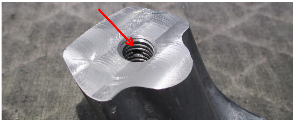
Kuva 33. Valussa esiintyy huokosia, jotka vaikuttavat kappaleen kierteen toimivuuteen.
