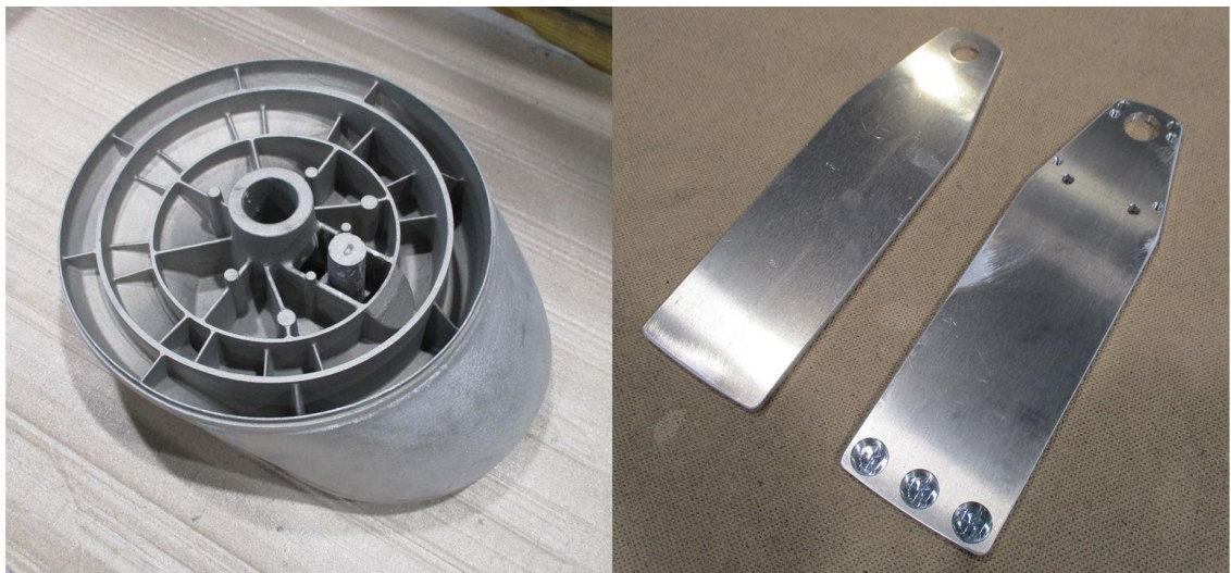
Kuva 9. Vasemmalla valuaihio ja oikealla laserleikattu aiho.
