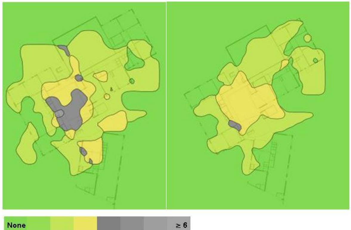
KUVA 12. Päällekkäiset kanavat (Channel Overlap). Vasemmalla 5GHz ja oikealla 2,4GHz taajuus. (Laakso 2017-09-30)
