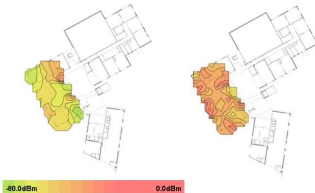
KUVA 19. Spektrin hyödyntäminen (Spectrum Channel Power) Jynkän koululla 1.krs luokkatilassa, vasemmalla 2,4GHz ja oikealla 5GHz taajuudella.
