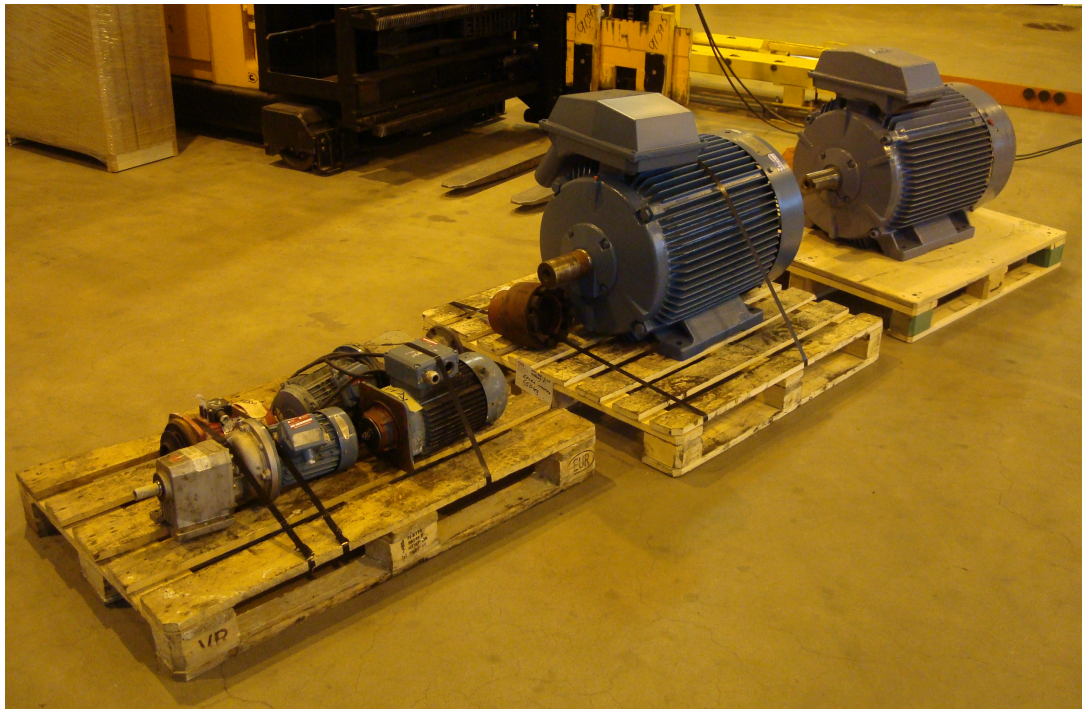
Kuva 4 Kuormalavat. Vasemmalta lukien kuvassa on EUR-lava, FIN-lava ja vanerinen kuormalava. Kuvassa sähkömoottorit odottavat kuljetusta.
