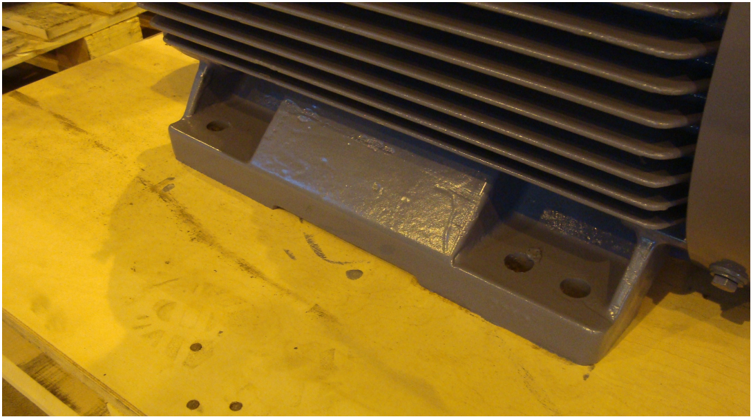
Kuva 3 Kiinnitys. Laitteissa olevia kiinnitysreikiä voidaan hyödyntää kuljetuksessa. Pulttaamalla laite kiinni kuormalavaan laite kestää vaativankin kuljetusmatkan.
