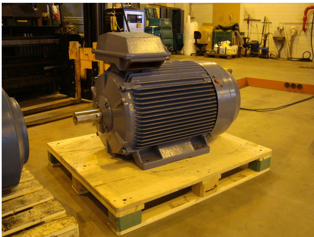
Kuva 2 Vanerinen kuormalava, jonka päällä sähkömoottori.
