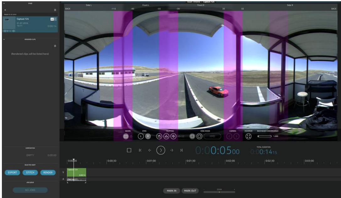
KUVA 15. OZO Creator-ohjelman stitchaussaumat ovat merkitty kuvassa pinkillä. Värjättyllä alueella kaksi eri kuvaa sekoittuvat toisiinsa, tarkoituksena tehdä huomaamaton saumakohta. Sauma-alueella on nähtävissä vääristymiä, joista useimmat yleensä korjautuvat renderöinnin seurauksena (Pepper 2017)
