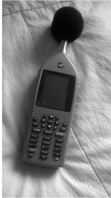
Kuva 5. Kuivurin äänenpaineentason seurannassa ennen takuuajojaksoa ja sen aikana käytettiin Norsonic Nor-132 luokan 2 äänitasomittaria.
