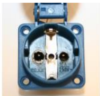
Kuva 24. Sähköautokäytössä ollut kotitalouspistorasia [25].
