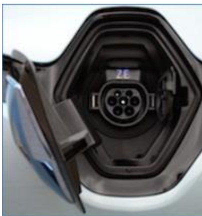
Kuva 23. Renaultin sähköautoissa käytössä oleva Chameleon-latausliitin [34, s. 45].
