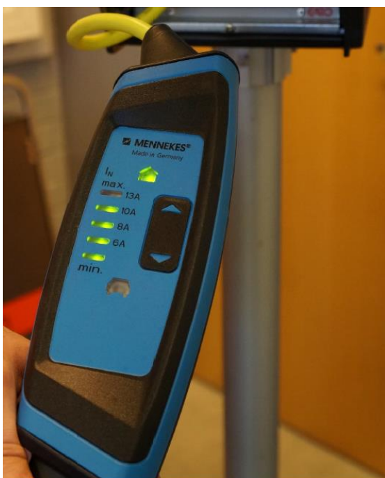
Kuva 16. Tilapäislatauskaapelissa oleva suojalaiteyksikkö [29].
