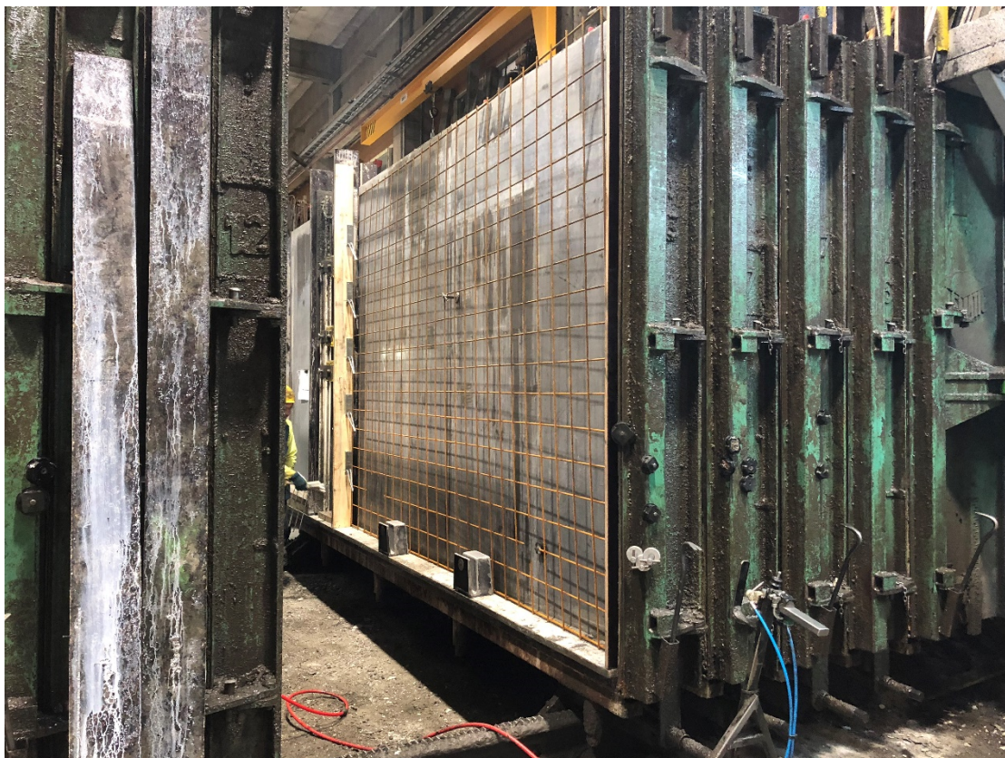
Kuva 33. Valokuva lisäkokeilun kohteena olleesta patterimuotissa valmistetusta elementistä, johon toinen verkko on jo asennettu paikoilleen. (Leinonen 2017)
