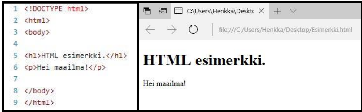
KUVA 11. Yksinkertainen esimerkki HTML -lähdekoodista ja kuva, miltä kyseinen esimerkki näyttää selaimessa.
