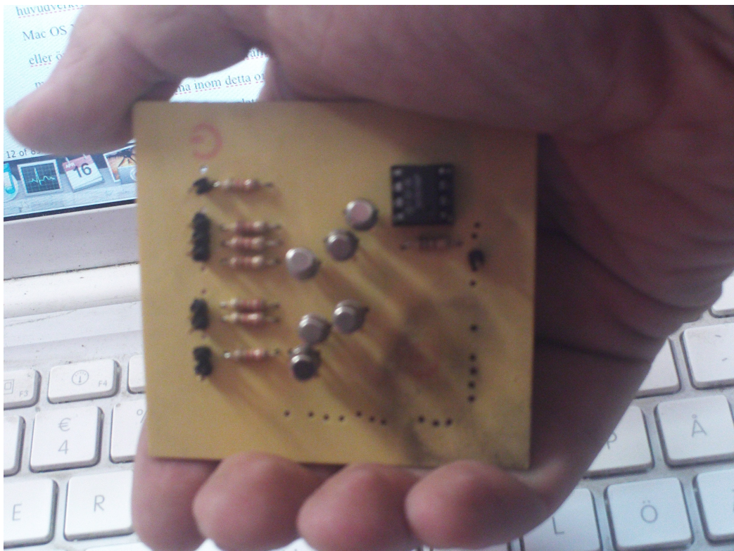
Figur 19. Kretskortet med alla komponenter förutom kontakterna.
