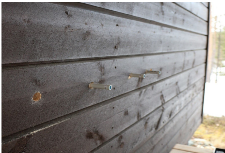
Kuva 141. Porareikämittausputket Wellevin koetalolla
