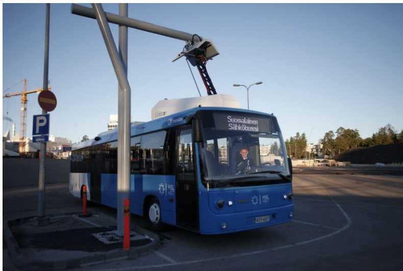
Kuva 5. Suomalainen Linkker-sähköbussi latauksessa päätepysäkillä Helsingissä. (HSL, 2015)
