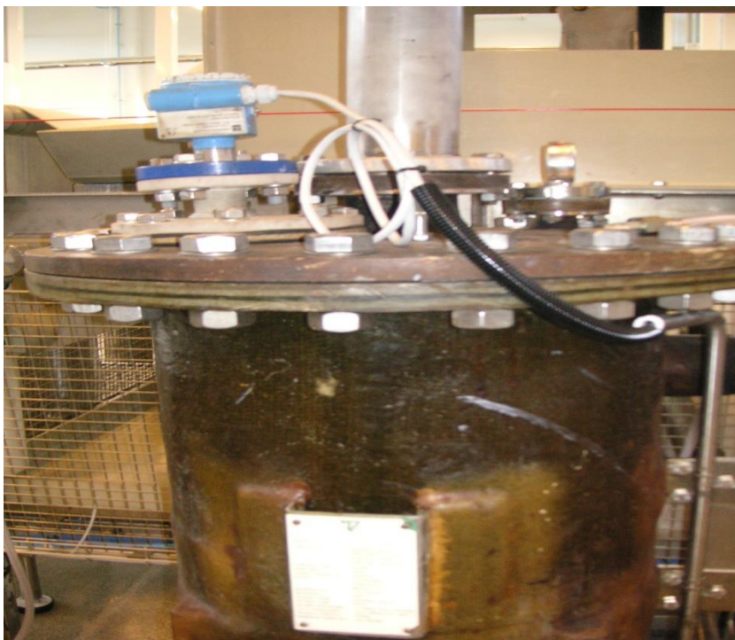
Kuva 12. Suodostankki jonka päällä pinnankorkeusanturi.
