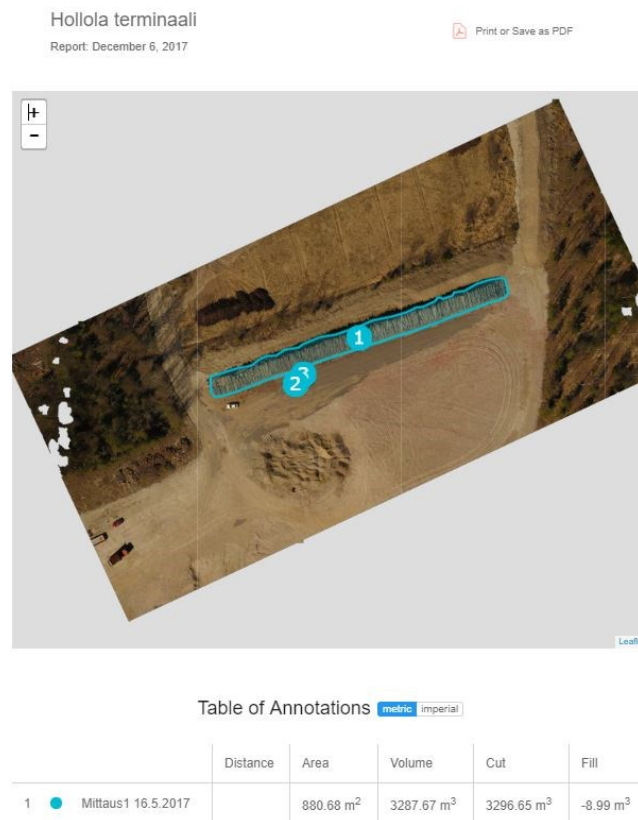
Kuva 7. DroneDeploy-ohjelmiston tuottama raportti Hollolan energipuuterminaalin massalaskennasta (Mäkinen 2017)
