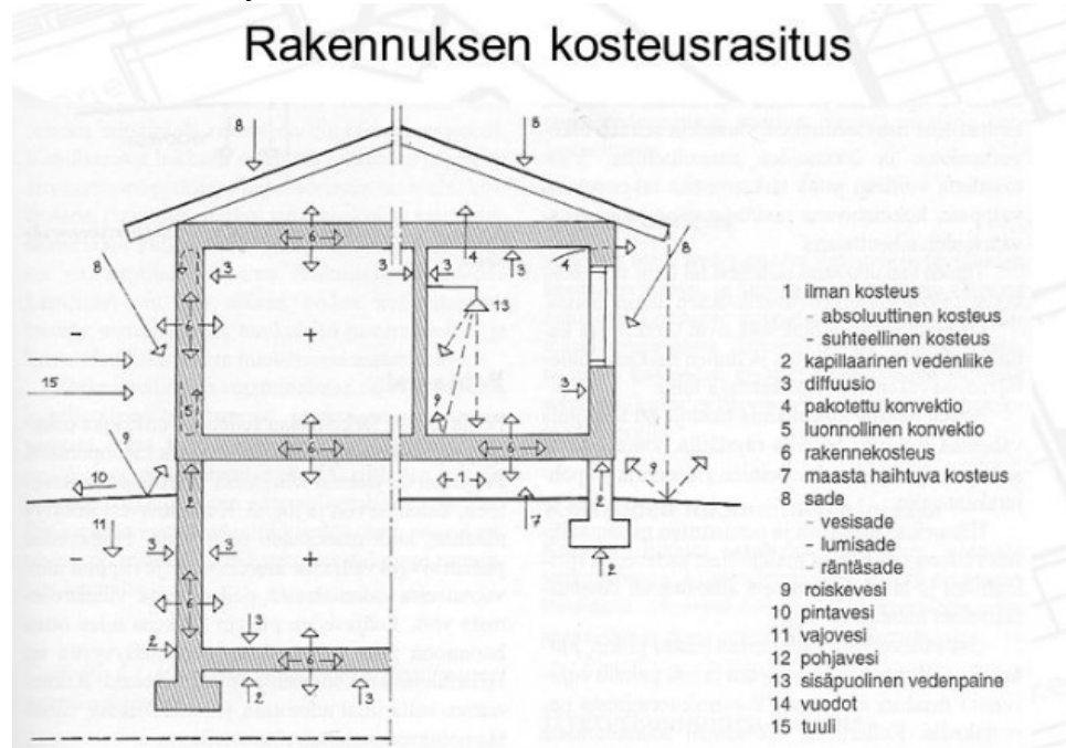
Kuva 1. Rakennuksen kosteustekniseen toimintaan vaikuttavia rasituk- sia. (Siikanen 2014, 65)
